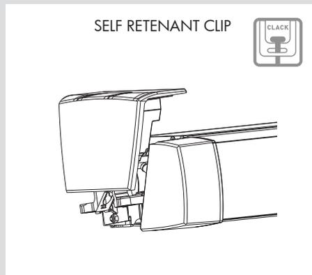
Le clip auto-agrippant intégré dans le support permet de suspendre le store sans avoir à supporter son poids lors de l'installation.
