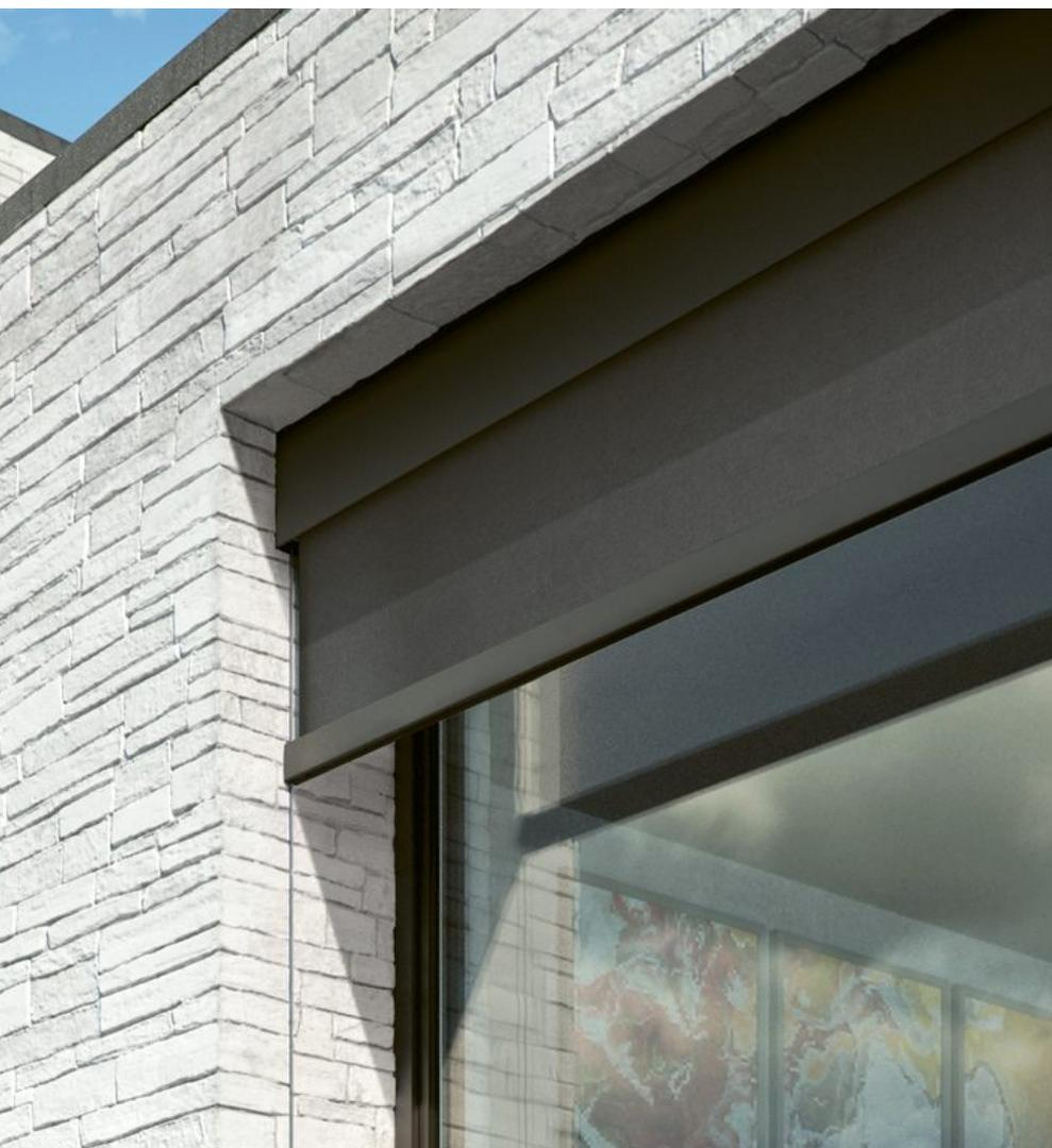
Power spring system est un système unique et innovant qui, grâce à des ressort à gaz, permet au tissu d'être tendu de manière continue et homogène dans n'importe quelle position où il est arrêté.
